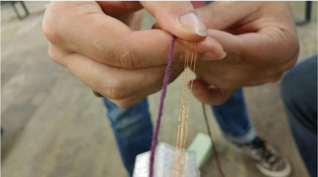
一旦每根电线加倍, 我们仍然需要 4 根线来驱动 LED (VCC, GND, 数据输入, 数据输出)。
