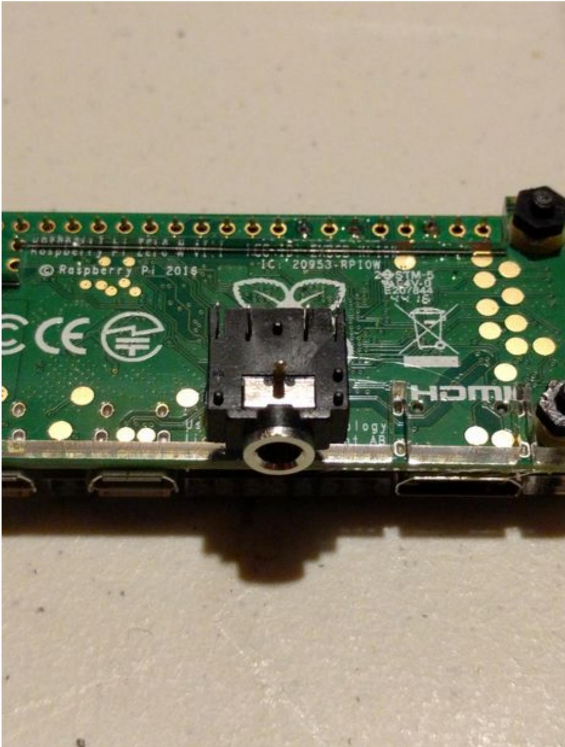
为确保使用的导线和修改 **Raspberry Pi** 更加模块化, 我热粘了一个 1/8 英寸耳机音频插孔到外壳并连接电线到插孔。使用带有匹配插头的耳机线连接红外 **LED**, 因此该导线可以连接到任何其他的位置, 最后指向我想要连接的红外接收器设备, 但是可以很容易地从 **Pi** 拔下, 而不需要移除所有的电线。
