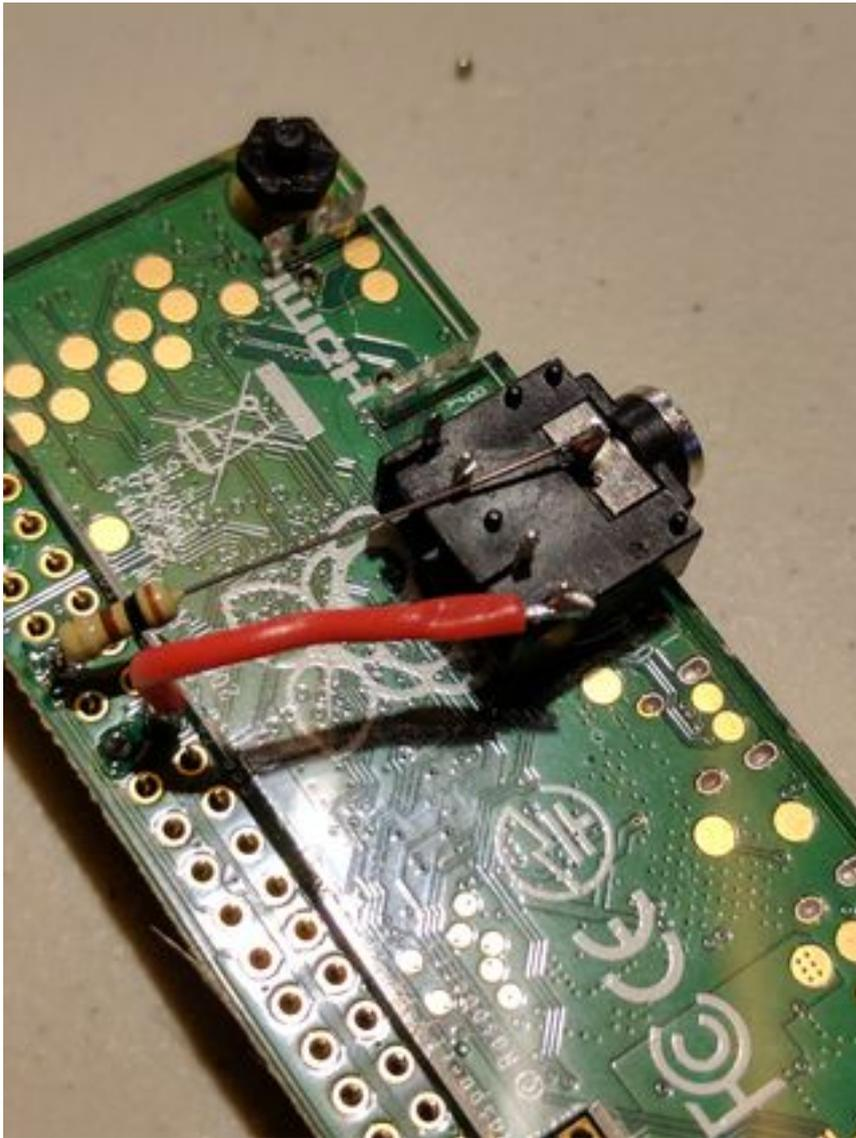
将红外发光 LED 连接到 Raspberry Pi 可以通过多种方式完成。这一步我使用了快速连接方式，我后来发现可能超出当前 Pi 引脚的电流门限。到目前为止，我没有遇到任何问题，但更为理想的连接方式将在下一步进行描述。
